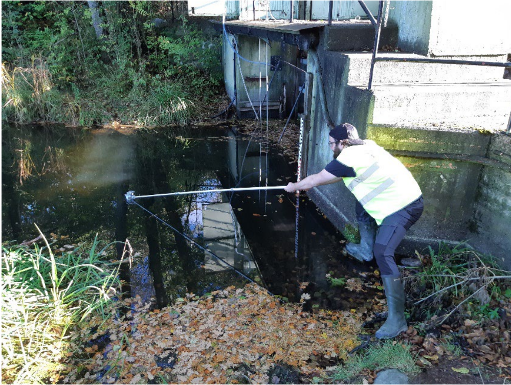
Figur 2. Ytvattenprovtagning med hjälp av fyrisåhämtnare med teleskopiskt utfällbart skaft.
