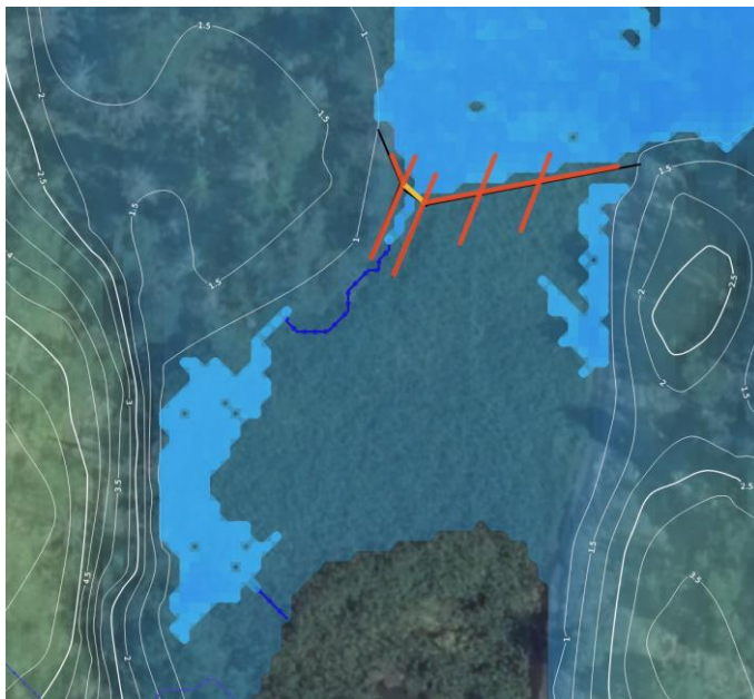
Figur 3: Dämme av altimmer med tvärsgående stockar som fungerar som strävor och reglerar vattenflödet genom ett v-format utlopp (gult). Stockarna som ligger nedtryckta i torv är av al som återfinns lokalt. Al har historiskt använts för konstruktioner i vatten eftersom träslaget är rötbeständigt i den miljön.
