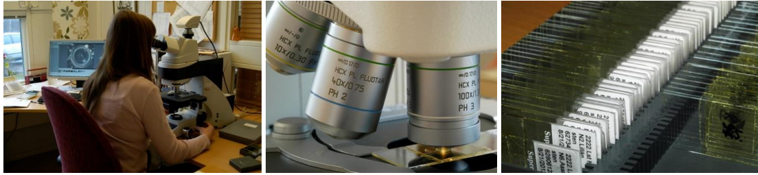
Figur 1. Kiselalgsanalys görs i ljusmikroskop i 1000 gångers förstoring med oljeimmersionsobjektiv. Mikroskopet ska helst vara utrustat med interferenskontrast, vilket gör att man kan se mycket små former tydligare än med andra tekniker.
