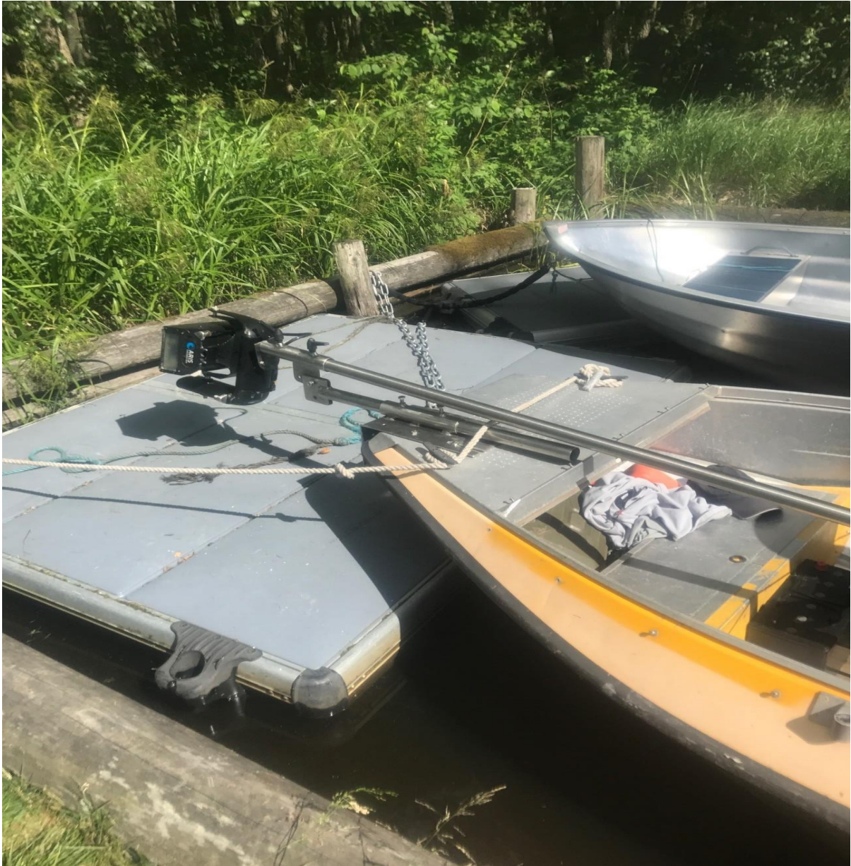
Figur 2. Inventeringen utfördes med hjälp av med sonarkamera (ARIS Explorer 1800, Sound Metrics corp.). ARIS ses på bilden monterad i fören på båten, med denna infästning var det möjligt att snabbt sänka ned eller ta upp ARIS, samt göra djupjusteringar. Den svarta bygeln som själva kameran är monterad inuti är styrmotorn Rotator.
