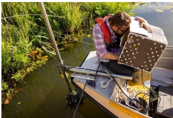
Figur 3. Filmning med ARIS, en akustisk kamera helt oberoende av ljud som skapar en bild utifrån ljud. Funktionen går att likställa vid dagens ekolofsteknik. Foto: Rickard Gustafsson.
