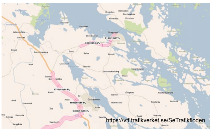
Figur 34: Trafikflödeskarta över Östhammar och Öregrund. Vänstra siffran är årsmedeldygnstrafiken, siffran inom parentes är mätåret och procentsiffran är ett mått på osäkerheten. Bandens bredd är proportionella mot årsmedeldygnstrafiken.
