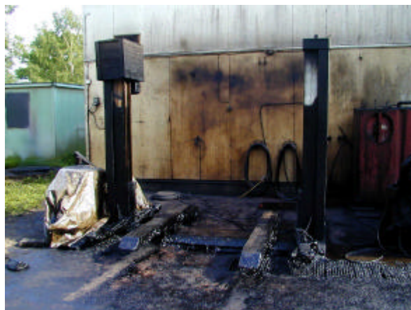
Figur 13. Rostskyddsbehandling av bilars underrede innebär stora risker för förorening om försiktighetsåtgärder inte vidtas. Verksamhet utomhus av detta slag (som bilden visar) är inte tillåten! (Foto Camilla Andersson)
