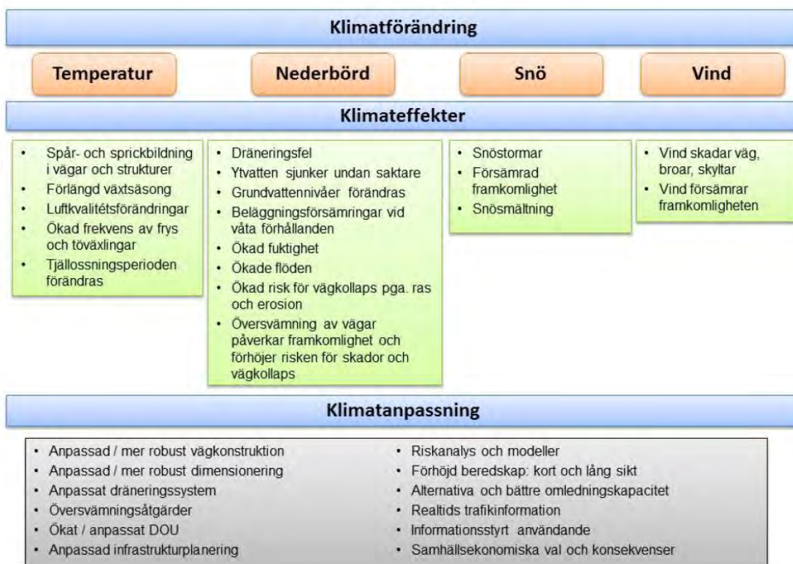
Figur 19. Översikt över klimatförändringarna som påverkar vägtransportssystemen, de specifika klimateffekterna som förväntas påverka samt exempel på klimatanpassningsåtgärder (Arvidsson m.fl. 2012)
