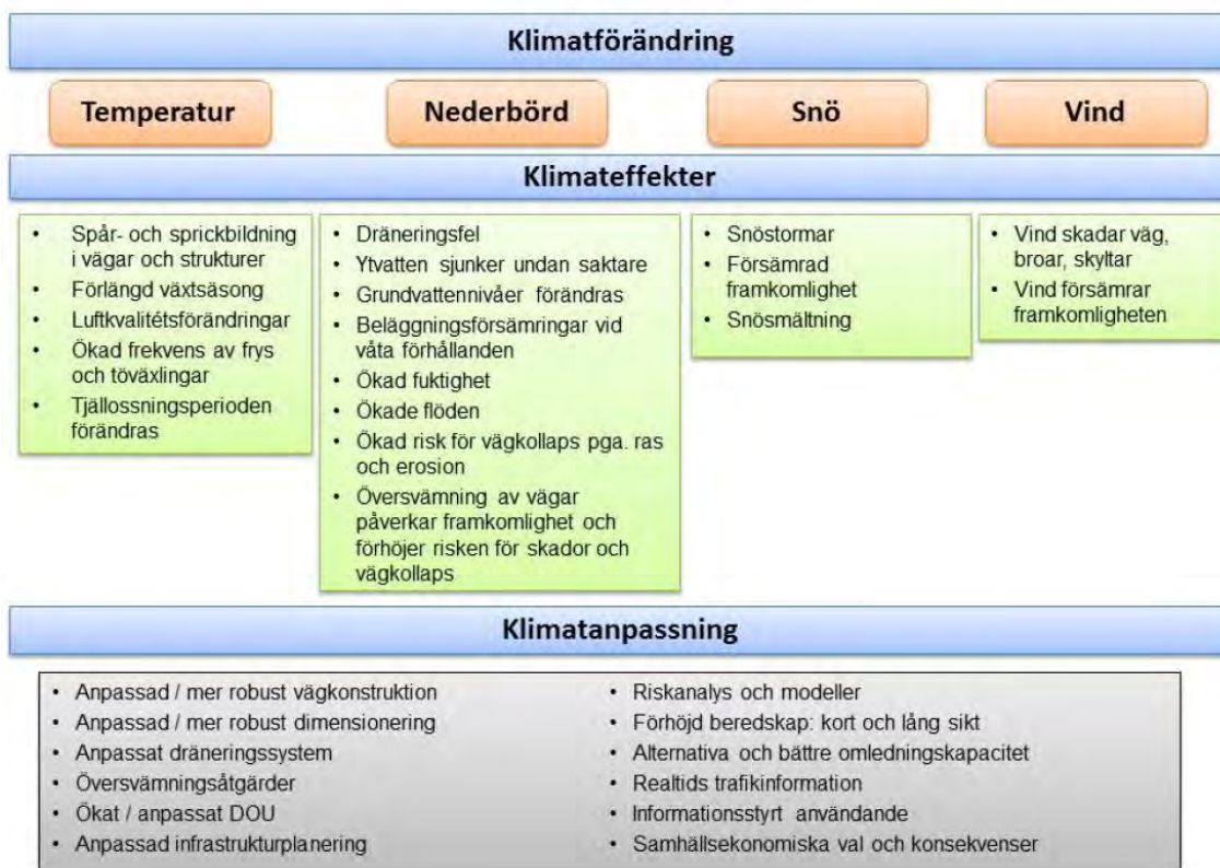
Figur 18. Översikt över klimatförändringarna som påverkar vägtransportssystemen, de specifika klimatklimat effekterna som förväntas påverka samt exempel på klimatanpassningsåtgärder (Arvidsson m.fl. 2012)
