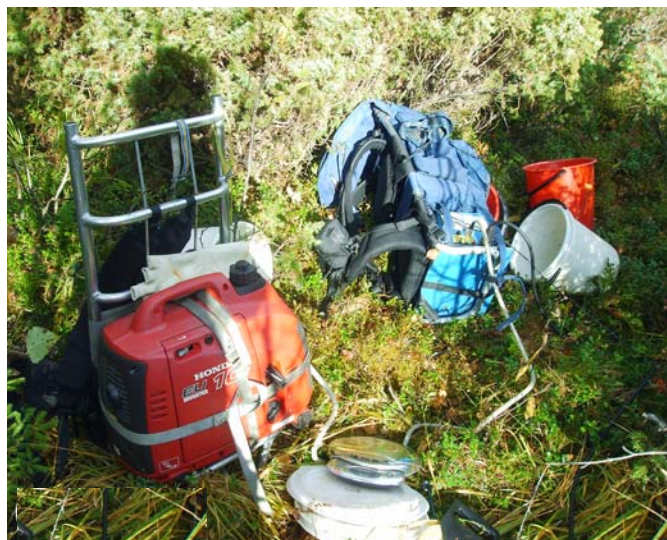
Elverket till vänster är monterat på en s.k brandkårsram. Transformatorn till höger sitter på en ryggsäck. I ryggsäcken bärs även kabeln.
