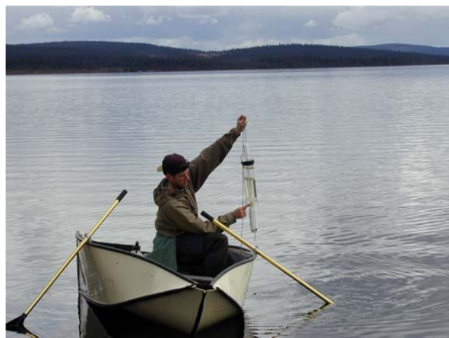
Vattenprovtagning med Ruttner-hämtare.
