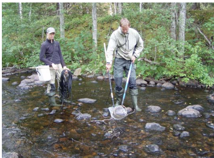
Halvard elfiskar. Vid elfisket förs staven mot håven. Det elektriska fältet gör att fisken dras mot staven. Linda bär kabeln och hinken med fisk. Hon har även en mindre håv som främst används för att plocka upp mindre fisk som fastnar mellan stenar.
