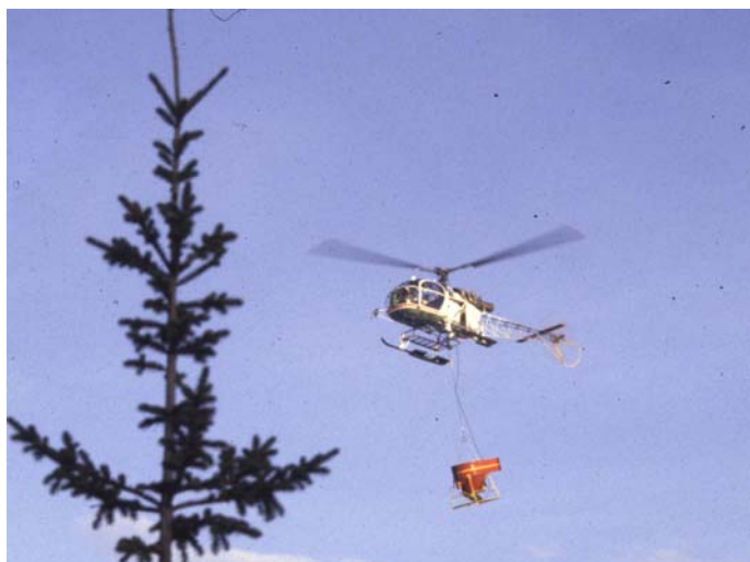
Första helikopteralkningen i Västerbotten. Cassel Aero sprider olivin med en helikopter av typen Lama.
