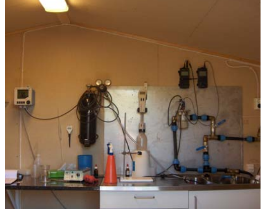
Utrustning för kontinuerlig mätning av pH i Stridbäcken. Övre bilden visar stugan som hyser utrustningen och nedre bilden pH-mätaren. Foto: Jorun Storeng.
