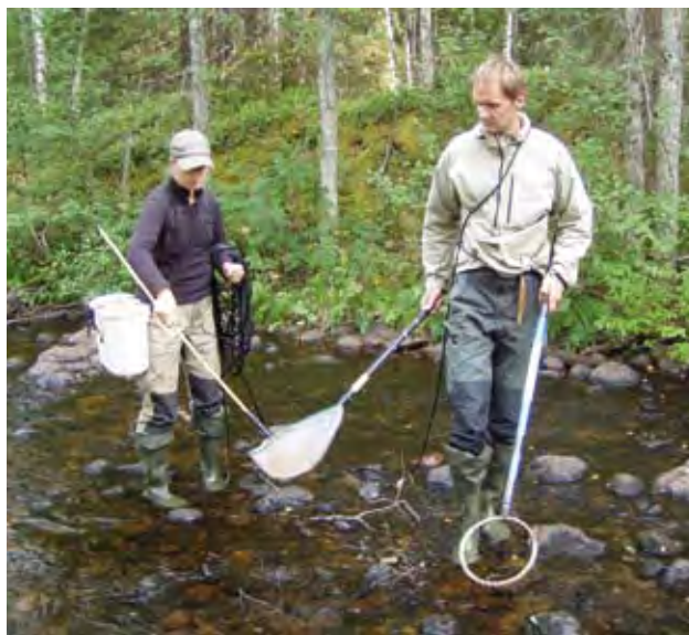
Elfiske används för att övervaka fiskbestånd i rinnande vatten. Fisken bedövas med elektricitet och kan därefter fångas med håv. Efter att fisken mätts och vägts släpps den tillbaka till vattendraget.
