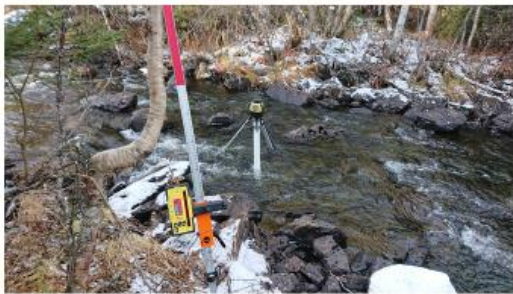
Mätning av lutning mha laser
