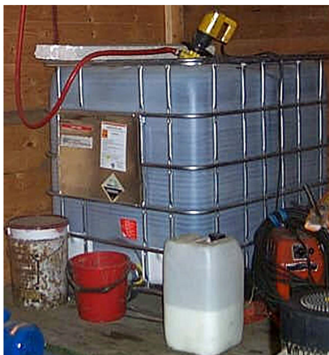
Figur 5. Behållare med kemikalie (Kemwood ACQ 1900) på en anläggning för träimpregnering (Arkivbild Länsstyrelsen Västmanlands län).
