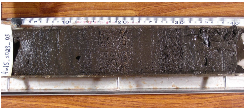
Bild 25. Sedimentkärna. Mellan 11–31 centimeter utgörs sedimentet huvudsakligen av massafibrer vilka på denna bild syns som ett porösare material än den mer kompakta leryttjan över och under fiberlagret. Foto: SGU.
