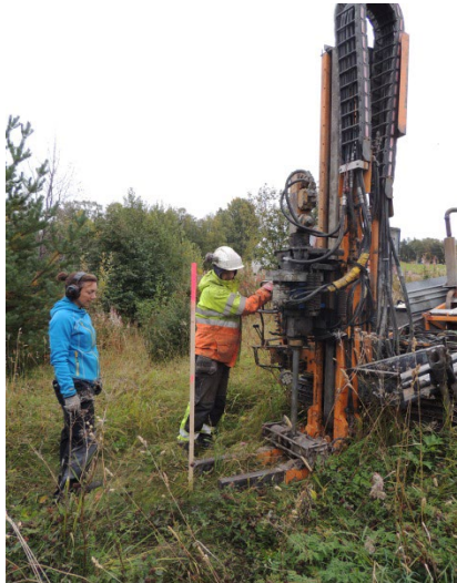
Bild 6. Provtagning med skruvborr. Foto: Länsstyrelsen Jämtlands län
