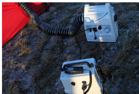
Dieselvärmare med batteriläda till skadeplatstält.
