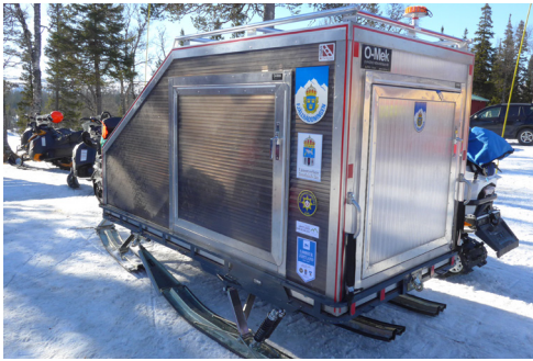
Väderskyddad transportpulka i kanalplast för skadade. Utrustad med belysning och värme. Den går även att använda på en terrängvagn sommartid.
