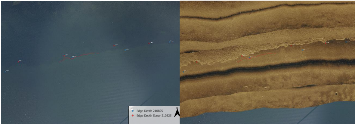
Figur 6. Exempel på jämförelse mellan drönar-mosaik (till vänster) och sonar-mosaik (till höger) från lokalen Fladholmen i Havstensfjorden 2021. Röda och blå punkter visar provtagningspunkter från side-scan respektive den manuella metoden med uppmätt djup i meter.
