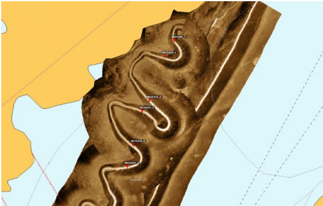
Figur 3. Exempel på hur down-scan inhämtas i ett sicksackmönster med utsatta markeringspunkter för vart ålgräsängens djupkant ligger (röda punkter).
