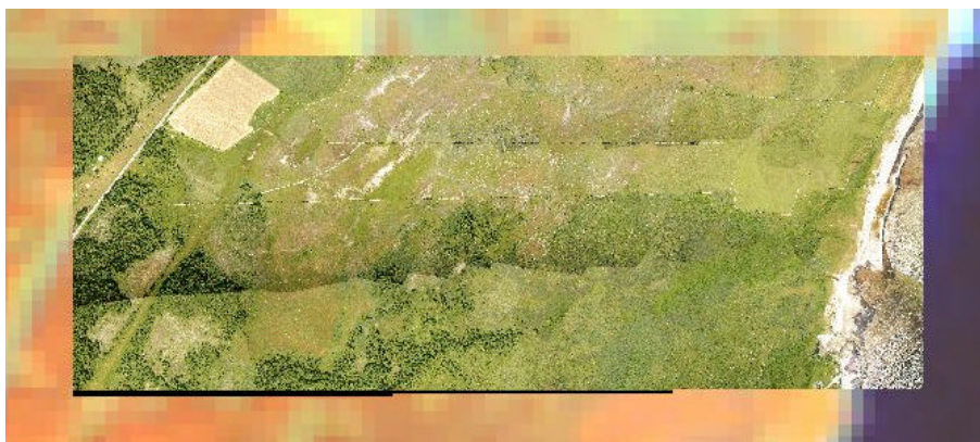
Figur 6. Exempel på specialbeställd flygbild (2002-06-18). Bilden motsvarar det sydligaste flygbildsområdet i Figur 5. Flygbilden är ca 1,7 km i x-led. Bakom ligger Landsat TM (2001-07-25) i en falsk färgsättning (RGB= TM4, TM5, TM3).
