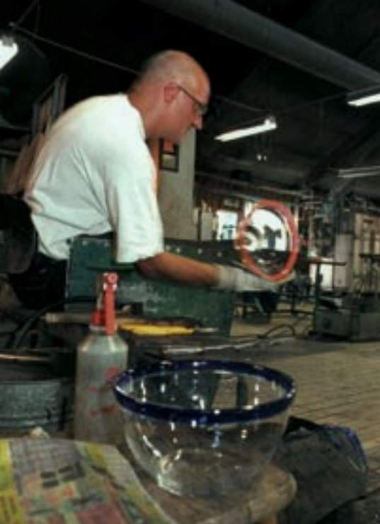
Den blå randen är ett kännetecken för glas från Bergdala. Th gjutning av glas i form. Formar och glablåsarpipor var sådant som förr tillverkades i brukets egen smedja.
