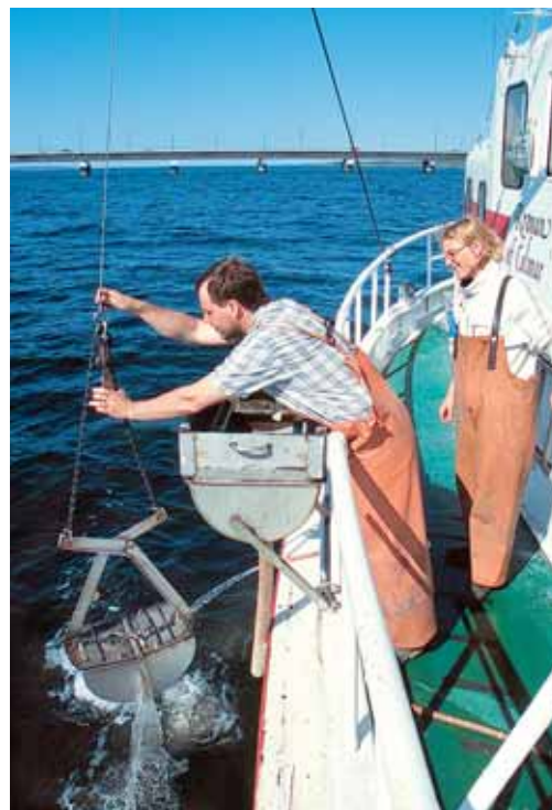
Den här bottenhuggaren är ett standardiserat hjälpmedel som forskarna använder för att få upp de djur som lever på mjukbottenarna. Stefan Tobiasson vid Högsolan i Kalmar arbetar med dessa undersökningar.
