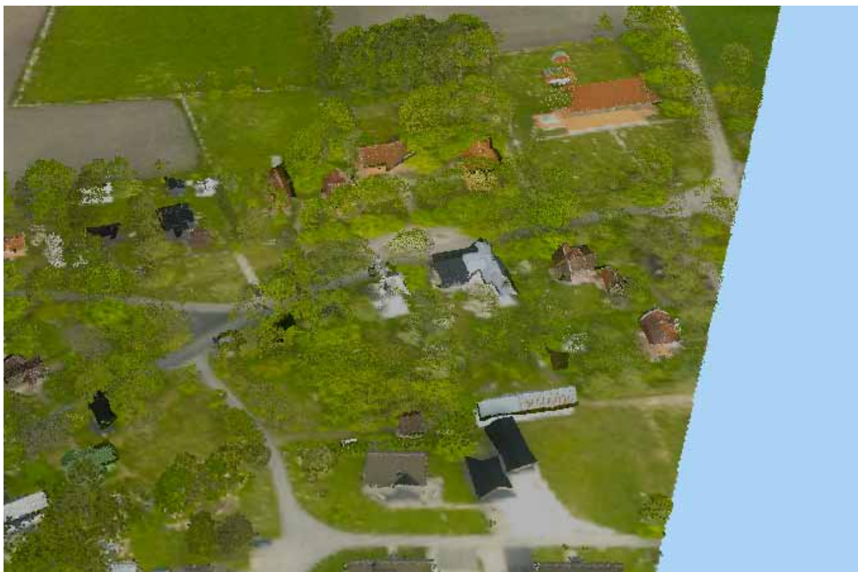
Bild 11: Samma vy som i bilden innan. Punktmolnen har tätats över taken. Här har punkttätheten satts till 10 cm vilket motsvarar upplösningen i flygfotot. Taken är nu skarpare, fortfarande saknas dock väggar.
