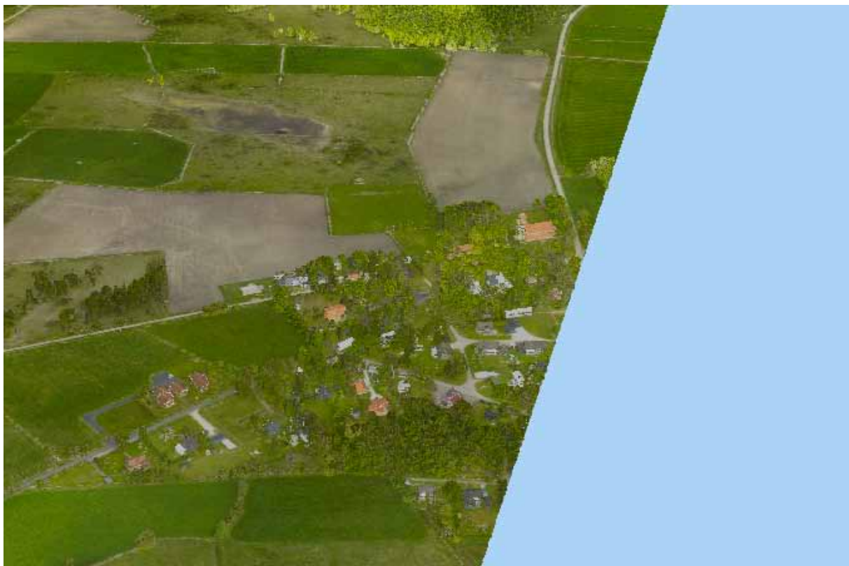
Bild 9: Flygvy över Löt. I bilden har punkterna i lasermolnet färgsatts utifrån flygfoton vid skapandet av byggnader och vegetation. På detta avstånd är både byggnader och vegetation verklighetstroga.
