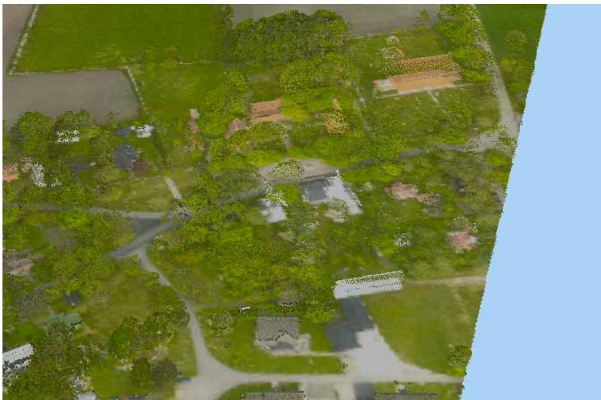
Bild 10: Visar vy över Löt som zoomats in från föregående bild. När byggnaderna zoomas in blir punktmolnen för glesa. Detta märks extra tydligt på kyrkan överst till höger i bilden. Punktmolnet måste förtätas.
