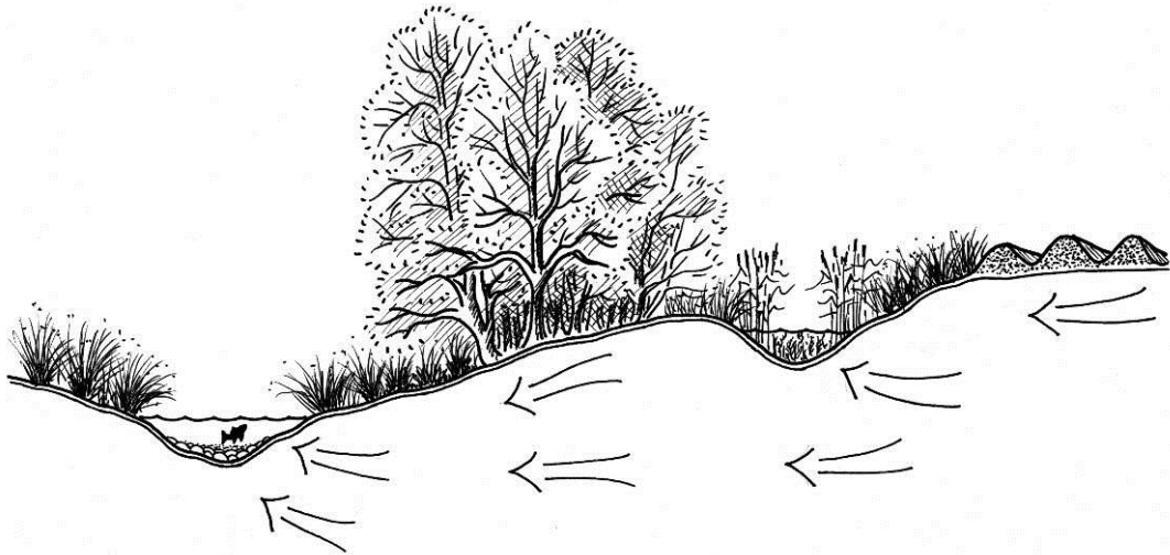
Figur 50. I det här exemplet på åplansrestaurering har en svacka grävts närmast åkerkanten till höger. Dessa svackor blir små våtmarker som kan ta hand om ytligt avrinnande vatten med höga kväve- och fosforhalter. Ill: T. Nydén.
