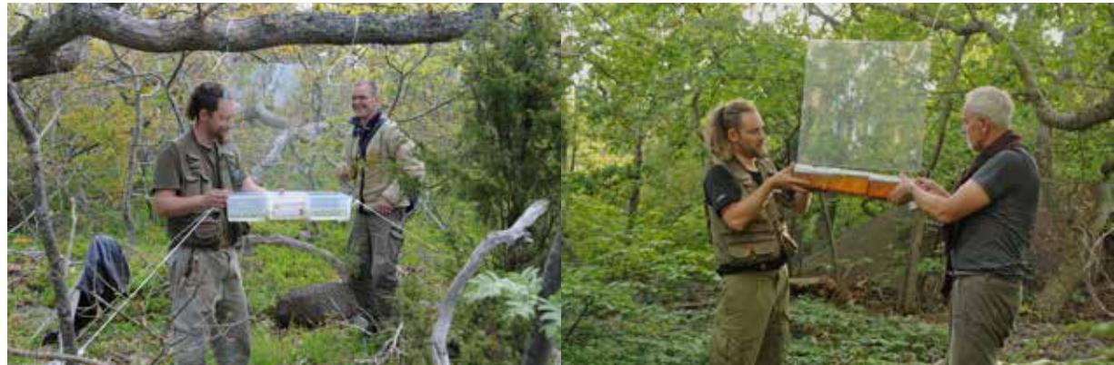
Figur 4. Barriärfällor. Första bilden visar uppmontering av fälla 025 under en ekgren, andra bilden visar nedmontering av fälla 006. Foto: första bilden Kurt Sahlin, andra bilden Ulla Sahlin.
