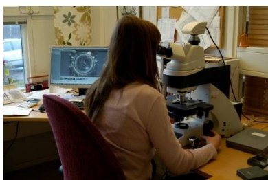
Figur 1. Kiselalgsanalys görs i ljusmikroskop i 1000 gångers förstoring med oljeimmersionsobjektiv. Mikroskopet ska helst vara utrustat med interferenskontrast, vilket gör att man kan se mycket små former tydligare än med andra tekniker.
