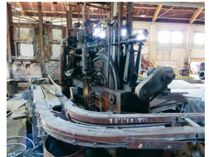
Den halvautomatiska flaskmaskinen i hyttan.
