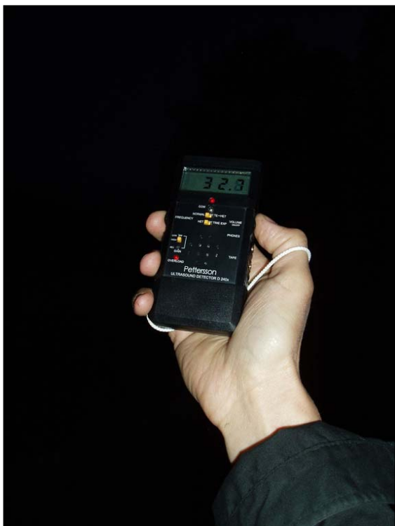
Foto 1. Vid inventeringarna används en detektor som registrerar fladdermössens ultraljud. Många av arterna går att skilja åt genom frekvensen på deras jaktlåten. Foto: Henrik Josefsson
