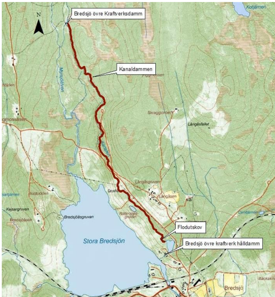
Figur 2. Karta över kanalen i Bredsjö. Kanalen leds mellan Bredsjö övre kraftverksdamm och Bredsjö övre kraftverkshålldamm. Innan hålldammen finns ett flodutskov
