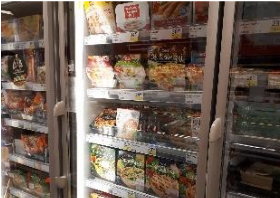
Bilden visar ett frysskåp där dörrar öppnas utåt vilket innebär svårigheter för personer i rullstol. Dörrarna saknar också kontrastmarkering.
