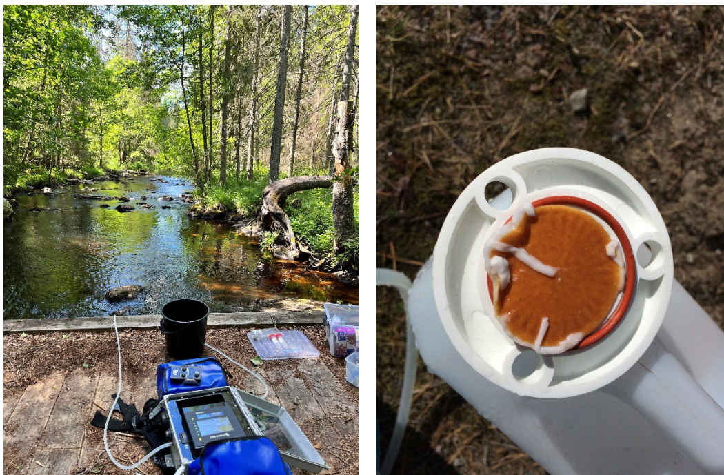
Figur 2. Det finns många olika typer av pumpar som kan användas för att filtrera vatten. Vänstra bilden visar ryggsäckspumpen som är en av de pumpar som använts inom projektet. Bilden till höger visar glasfiberfiltret efter att vatten filtrerats genom filtret.
