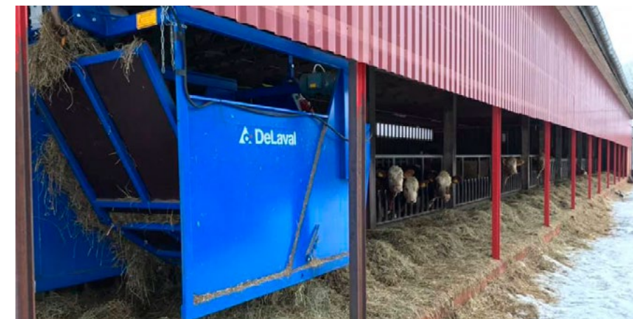
Den elektriska fodervagnen löper utmed hela foderbordet och ger en effektiv och smidig utfodring till djuren. Foto: Marie Larsson
