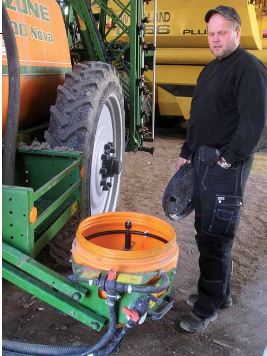
Richard Månskog visar sprutans preparatpåfyllare. Den är placerad så att man hela tiden kan stå på marken och inte behöva klättra upp på sprutan för att fylla på.
