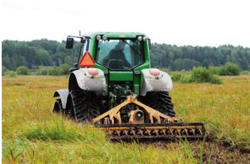
Lågt marktryck och hög framkomlighet möjliggör bearbetning av marker med dålig bärighet.
