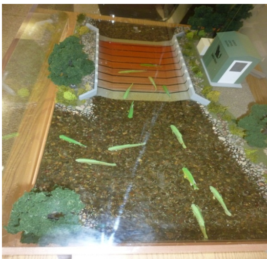
Figur 4. Modell av hur fisken reagerar när den vandrar in i området med strömförande vatten (bottenmonterad elspärr).
