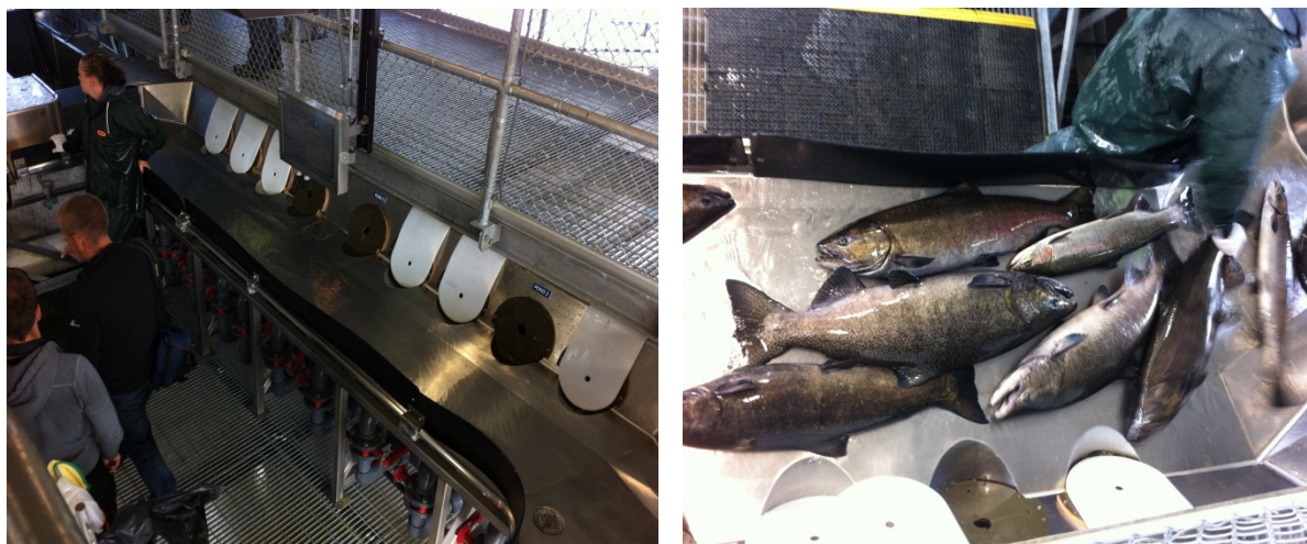
Figur 23. Efter bedövning sorteras fisken och førs till rätt bassäng eller till transport via luckor och førsystem.
