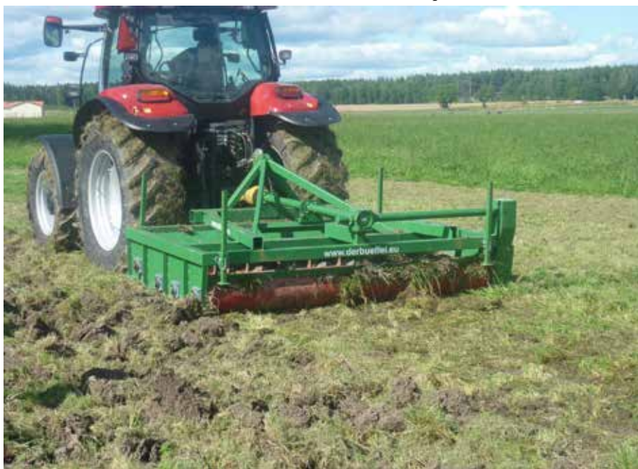
Redskap som återställer skadad vall.
