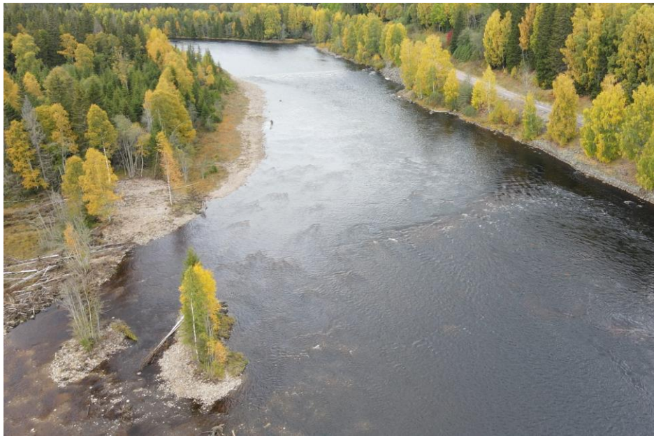
Figur 9. Restaurerat område i höjd med Bråten där sten och block återförts. De strömmande partierna är helt nya och däremellan har stora mängder större sten och block lagts ut som ståndplatser och skydd för fisk. Högra sidan orörd pga. riksväg 62.
