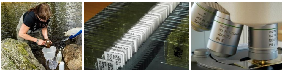
Figur 1. Provtagning av påväxt - kiselalger görs i första hand genom borstning av stenar varefter proverna prepareras kemiskt och kvarvarande kiselalgsskal fixeras på objektglas till permanenta preparat, som sedan kan analyseras i ljusmikroskop i 1000 gångers förstoring. Mikroskopet ska helst vara utrustat med interferenskontrast, vilket gör att man kan se mycket små former tydligare än med andra tekniker.
