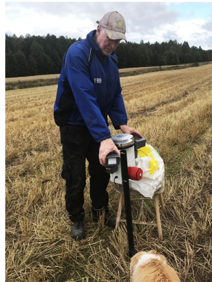
Ulf Pettersson ställer in rörelsesensorerna på fågelskrämman Fieldguard.
