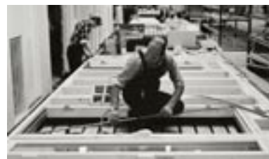
Arbetare på fabrik monterar förtillverkade väggelement för småhus. Platzers bildarkiv, Stockholms läns museum.
