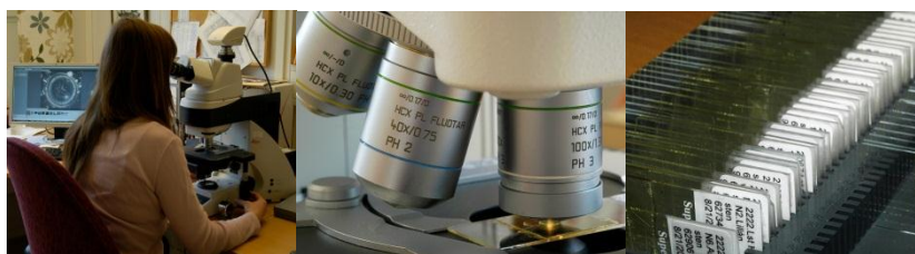
Figur 2. Kiselalgsanalys görs i ljusmikroskop i 1000 gångers förstoring med oljeimmersionsobjektiv. Mikroskopet ska helst vara utrustat med interferenskontrast, vilket gör att man kan se mycket små former tydligare än med andra tekniker, © Medins Biologi AB.
