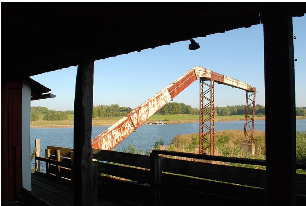
Den översta bilden visar ett transportband mellan sågvinden och rummet för spånhantering. Från detta rum kunde spån och liknande matas ut via den stora skraptransportören som syns på bilden ovan. Foto LKU 2014
