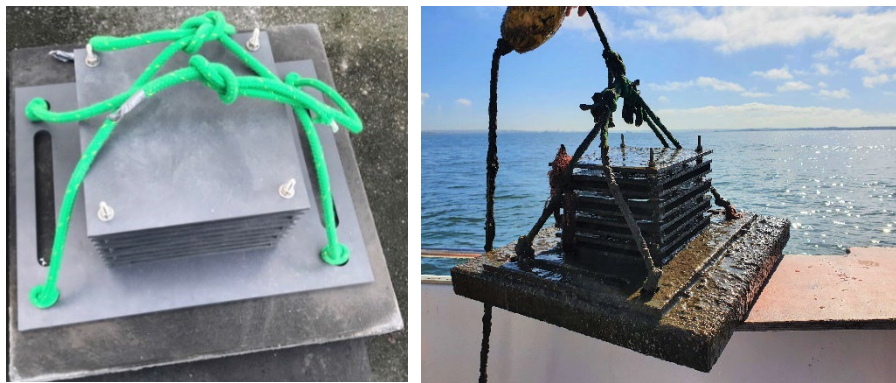
Figur 1. Ihopsatt ARMS system med betongplatta i botten färdigt att läggas ut. Påväxtpanel efter tre månader på botten i inloppet till Göteborgs hamn (Från Sundberg et al. 2022).
