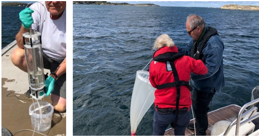
Figur 5. Ruttner vattenhämtare av den typ som används för insamling av vatten till eDNA-analys (Foto Lise-Lotte Sundberg) och planktonhäv (Foto Jens Kosterhed).
