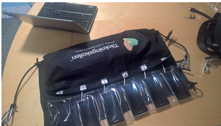
Mätinstrumentet består av fem telefoner seriekopplade till en gemensam strömförsörjning.
