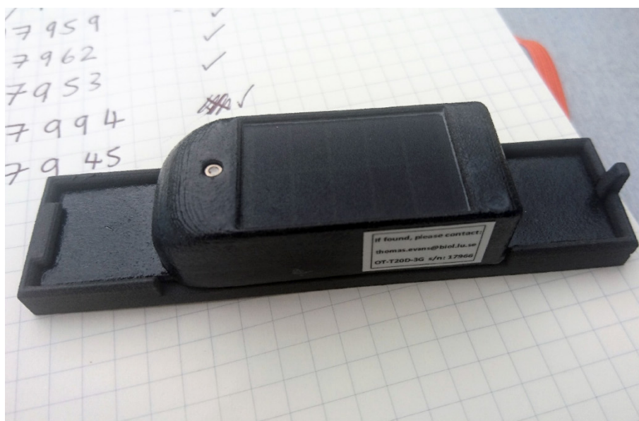
Fig. 1. Aktivitetslogger med solpanel och dyksensor (den vita cirkeln till vänster på utrustningen). Pappret i bakgrunden har 5 mm rutor. (Foto: Tom Evans).
