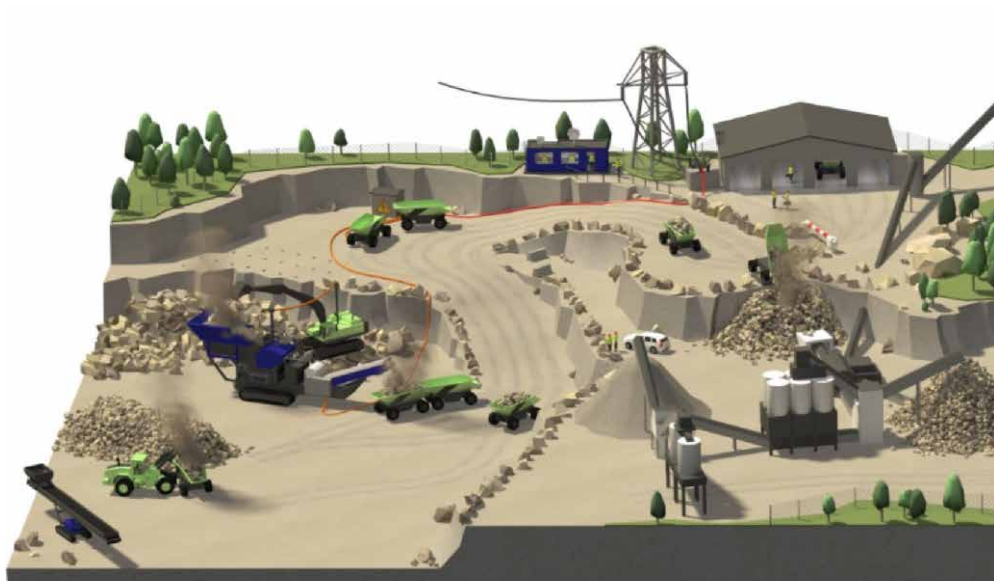
Figur 26: En helt automatisk, eldriven och förarlös bergtäkt – styrd av ett gemensamt datasystem presenterat av Volvo Construction Equipment på Energimyndighetens elfordonkonferens 2017 (32) . Bild: Volvo Construction Equipment, VCE.
