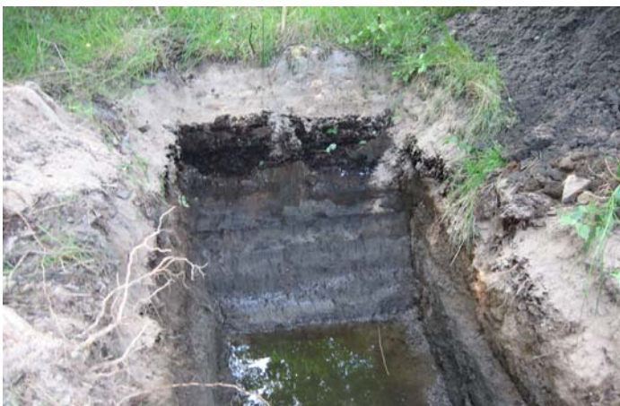
Figur 7.4. Foto av provgrop Pg 11 (väster om Bråtabäcken) med sandskikt, bräd- och barklager samt underliggande sand.
