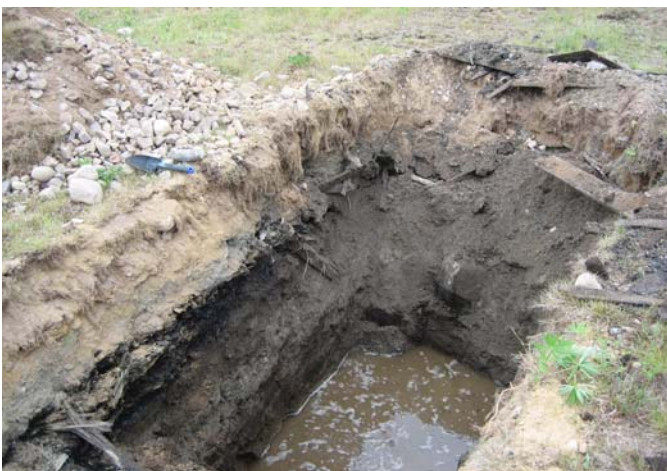
Figur 7.2. Foto av provgrop 6 med sandskikt, bräd- och barklager samt underliggande sand. Provgropen ligger strax söder om järnvägen, ca 30 m öster om pumpstationen
