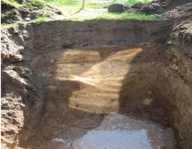
Figur 7.1. Foto av provgrop 26 med jordlager av sand belägen i den östra delen av undersökningsområdet nära Fibbleån.
