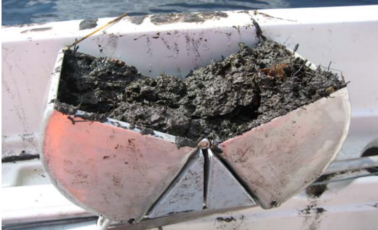
Figur 7.6. Gyttjiga sediment från Rottnen tagna vid den översiktliga karteringen av bottenförhållanden inför sedimentprovtagningen.
