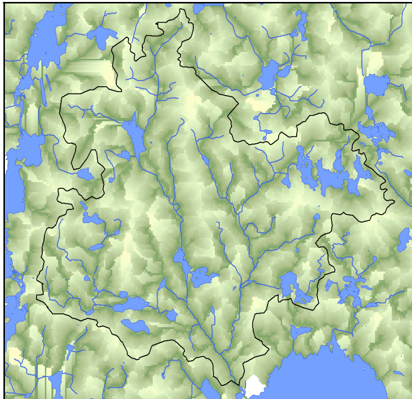
Figur 5 Beräknat avstånd till närmaste vattendrag. Ju ljusare färgen är desto längre tid tar det för vattnet att nå vattendraget. Pixelstorlek är 50 m.
