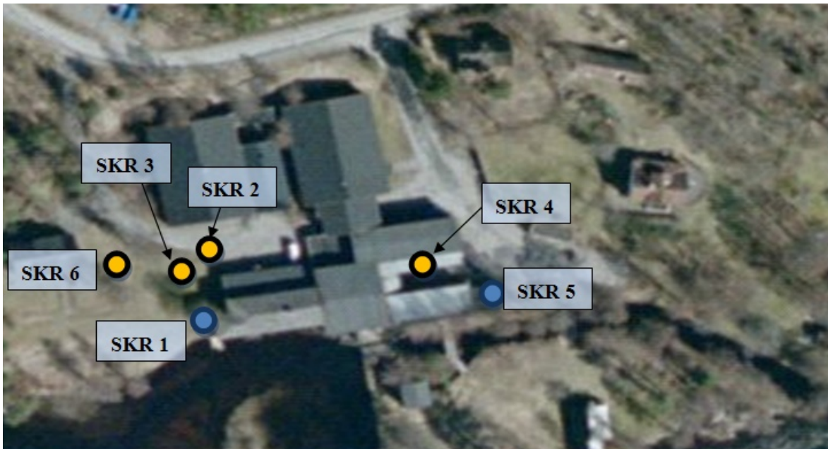
Figur 3 Provtagningspunkter, skruvborrning och installation av grundvattenrör.
