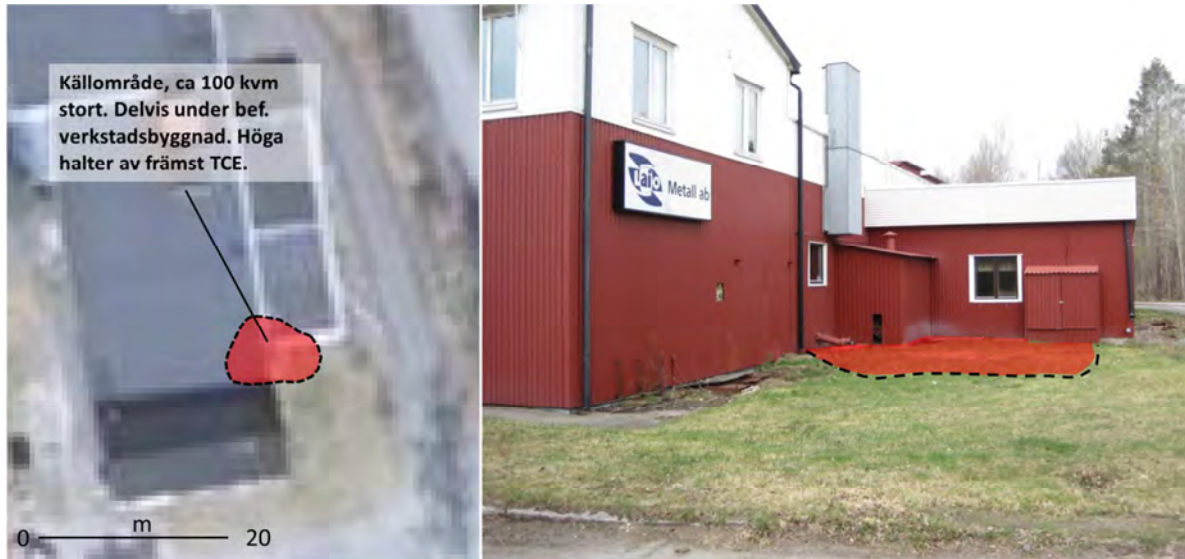
Figur 7. Maximal utbredning av det källområde där spill/läckage av klorerade lösningsmedel till marken har påvisats. Källområdet bedöms vara mindre än 100 kvm.
