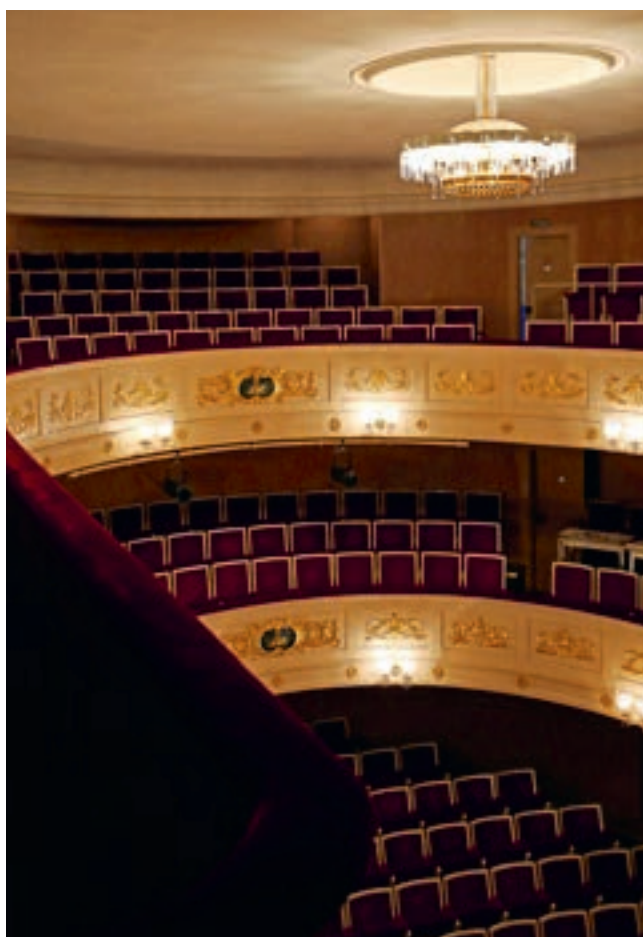
Den stora gaskronan, mitt i salongens tak, elektrifierades under restaureringen. Även detta utfördes efter arkitekt von Schmalensees noggranna övervakning.
