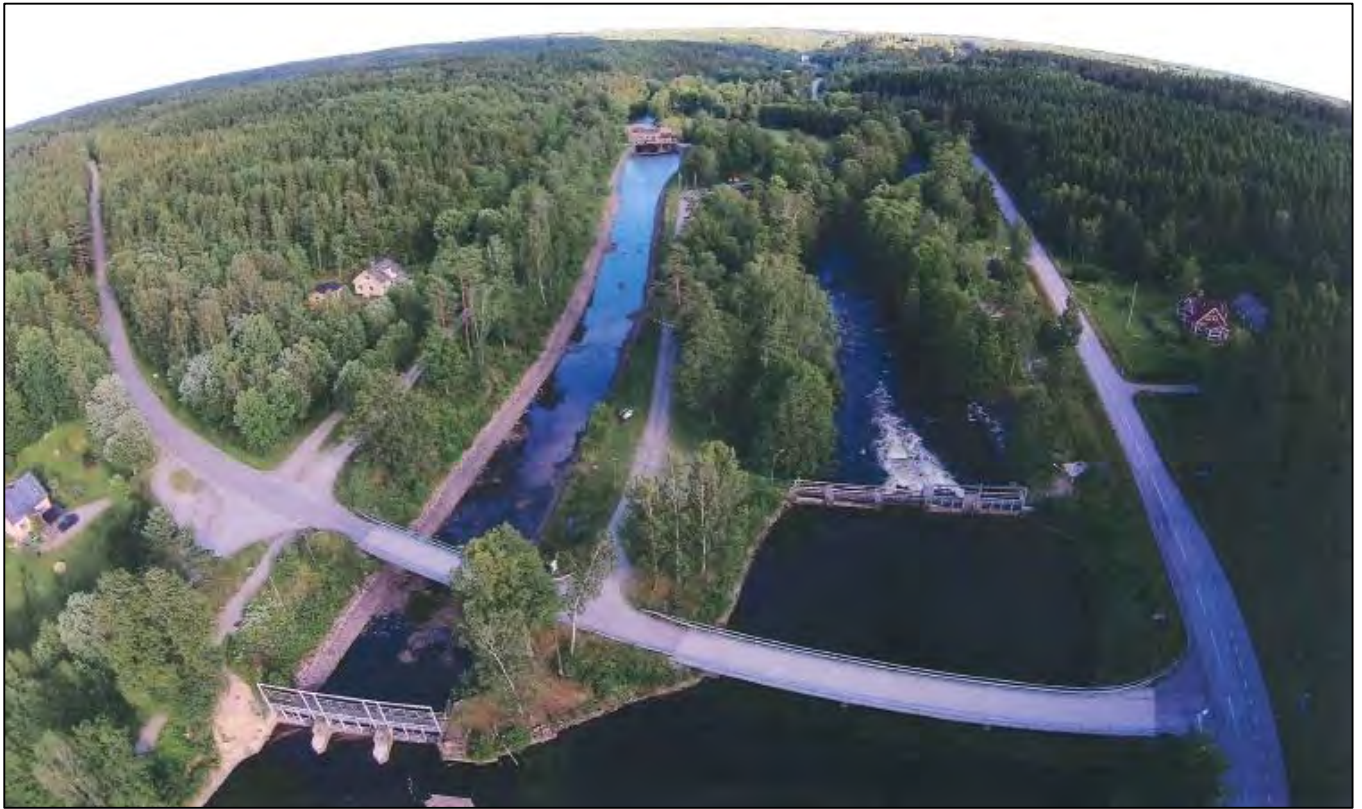
Bild 9. Ett flygfoto som tydligt visar hur vattendraget delar sig mellan intagskanal och den naturliga fåran. Bilden tillhör Frank Gunnarsson.
