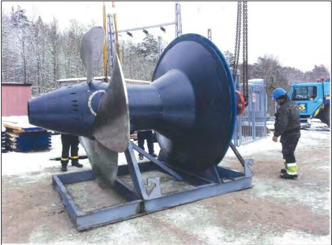
Bild 5. Den nya kaplanturbinen. Bilden tillhör Frank Gunnarsson.
