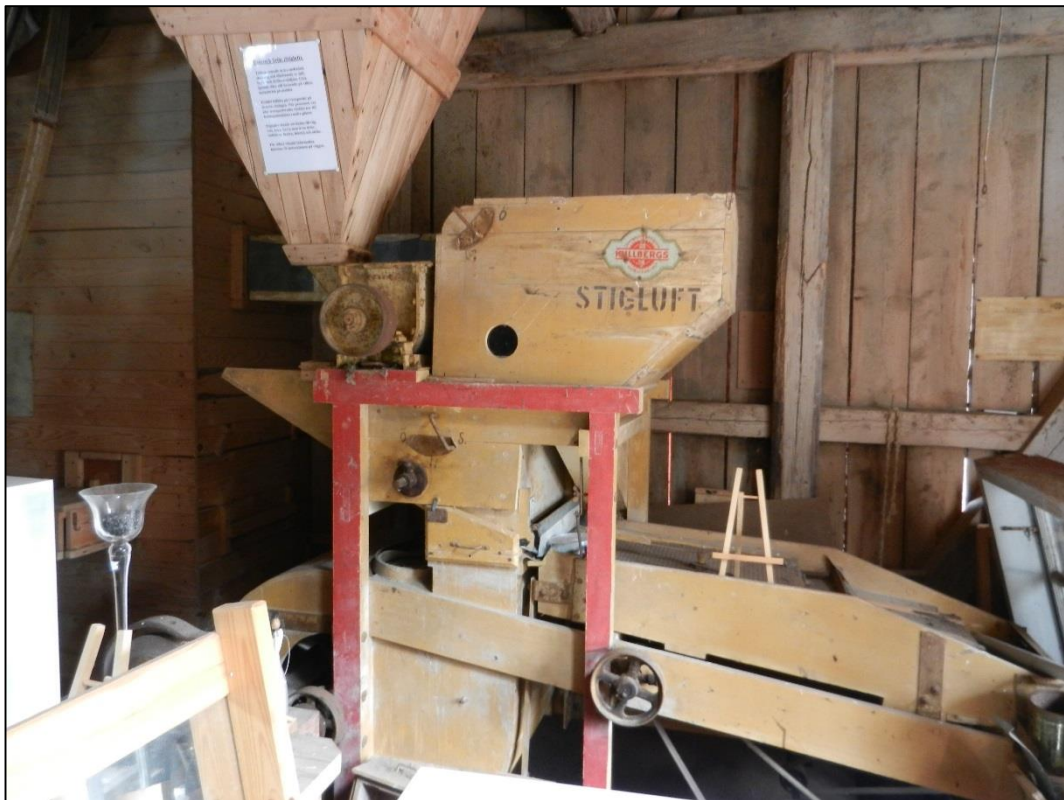
Bild 8. Ett rensverk för att skilja ogräs och dylikt ifrån utsädet.
