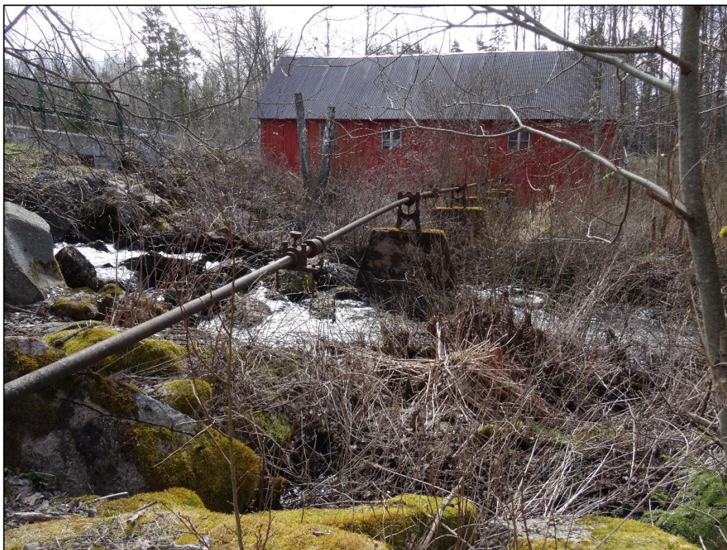
Bild 5. Ledarmen som förut ledde kraft mellan turbinen i kvarnen till sågen.
