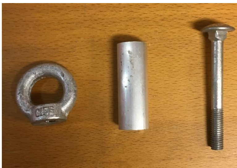
Fig 6: En lyftöglemutter, ett runt rör och en vagnsbult sätts fast i varje hörn på en ram.
