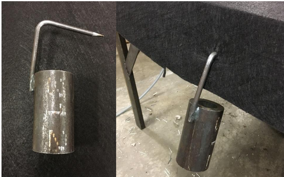
Fig 8: Duken tyngs ner över ramen men hjälp av egentillverkade tyngder. Den spetsiga änden gör det lätt att sätta fast tyngderna i duken.
