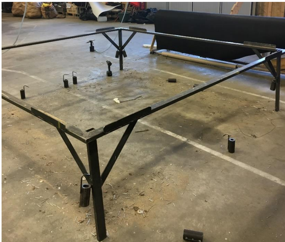
Fig 3: När en ram ska byggas eller repareras läggs den på en egentillverkad ställning som håller delarna på plats.
