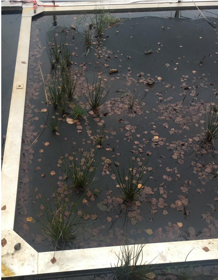
Fig 43: Växtlighet som rotat sig på fiberduken på de ramar som ligger närmast strandkanten försvårar upptagningen av ramarna.
