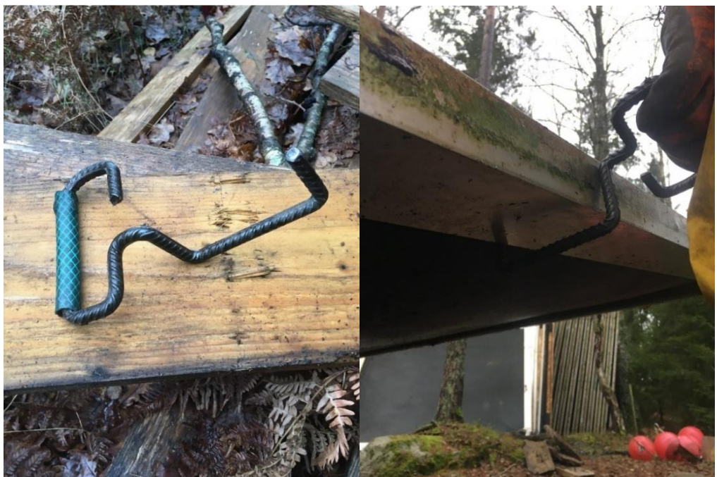
Fig 34: Den korta krokan används för att bära ramarna när de är blöta och hala.
