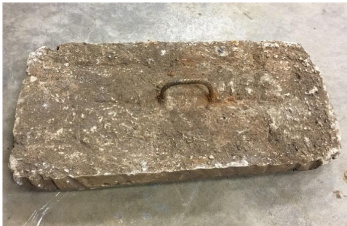
Fig 11: Ankarsten gjuten av betong, handtaget av armeringsjärn ska vara så stort att man enkelt kan få ett bra grepp med hela handen. På bilden är det i minsta laget.
