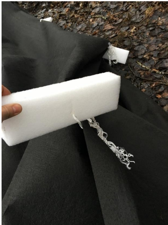
Fig 13: Flytelement på strandduken knyts fast med snören.
