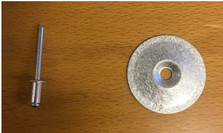
Fig 5: Popnit och isolerbricka som används för tillverkningen av ramarna.
