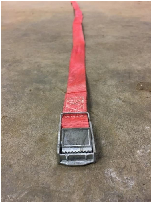
Fig 14: De en meter långa spännbanden används främst till att sätta ihop ramar men också till andra saker som att hålla ihop strandduk under transport, då behöver dock två eller flera spännband skarvas ihop.
