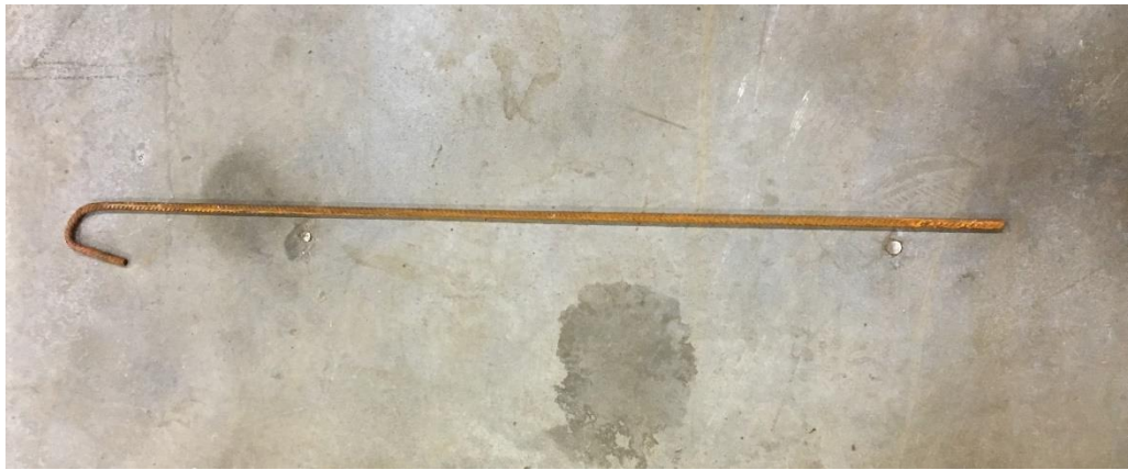
Fig 17: Armeringsjärn för att hålla ner duken i strandkanten.
