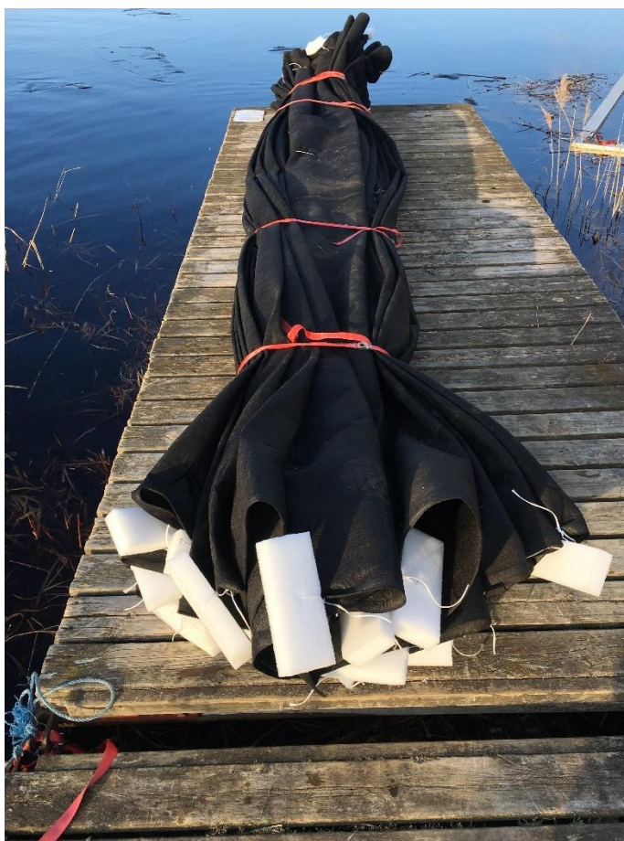
Fig 19: Den flytande duken, förberedd för utläggning.
